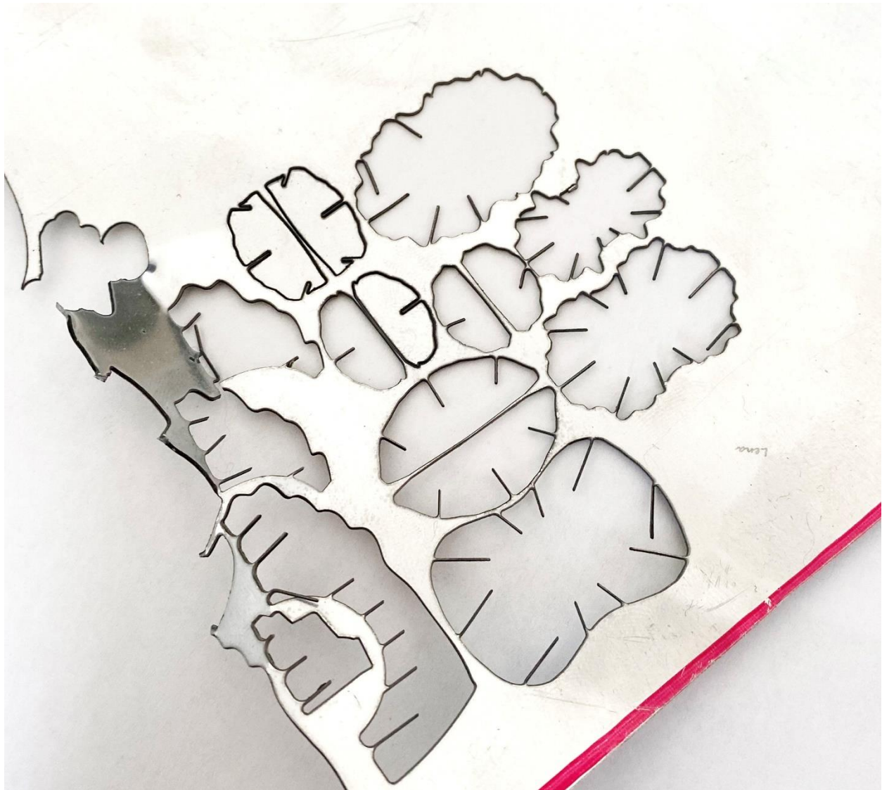
Il 2. 68 Alumiuniowa blacha po testowych cięciach lasera. Źródło: opracowanie własne.
