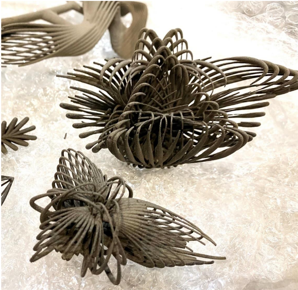
Il 2. 20 Wadliwe druki oraz charakterystyczne mikro zapadnięcia wyglądające jak dziury w modelu. Źródło: opracowanie własne.
