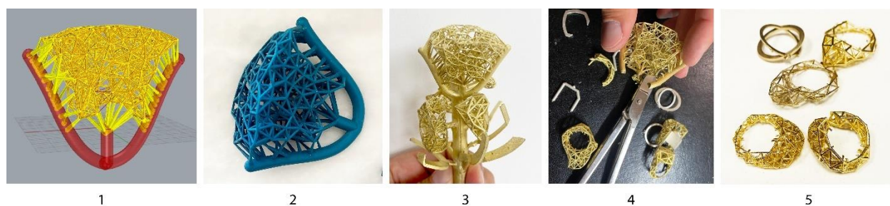
Il. 2. 83 Proces odlewania od projektu po gotowy odlew. 1.) Zaprojektowany model wraz z kanałami dolewowymi. 2.) Wydruku w wosku. 3.) Choinka z odlewami. 4.) Precyzyjne odcinanie odlewów z choinki. 5.) Odcięte odlewy gotowe do dalszej obróbki. Źródło: opracowanie własne.
