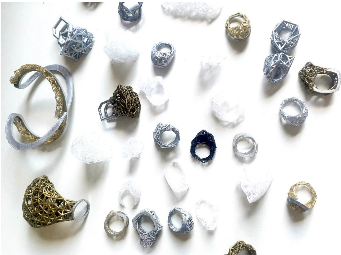
Il. 2. 84 Wydruki z drukarki 3D firmy Formlabs . Część z tych modeli została zabarwiona w celu przetestowania różnych kolorów i sprawdzenia ich wizualnego efektu. Źródło: opracowanie własne.
