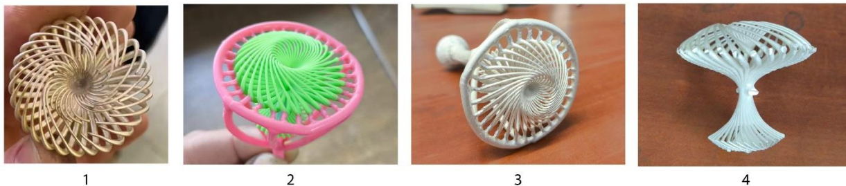
Il 2. 18 1.) Jeden z nieudanych odlewów. 2.) Dodanie większej ilości kanałów dolewowych do głównej formy. 3.) Surowy odlew wraz z kanałami 4.) Odlew po odcięciu kanałów. Źródło: opracowanie własne.
